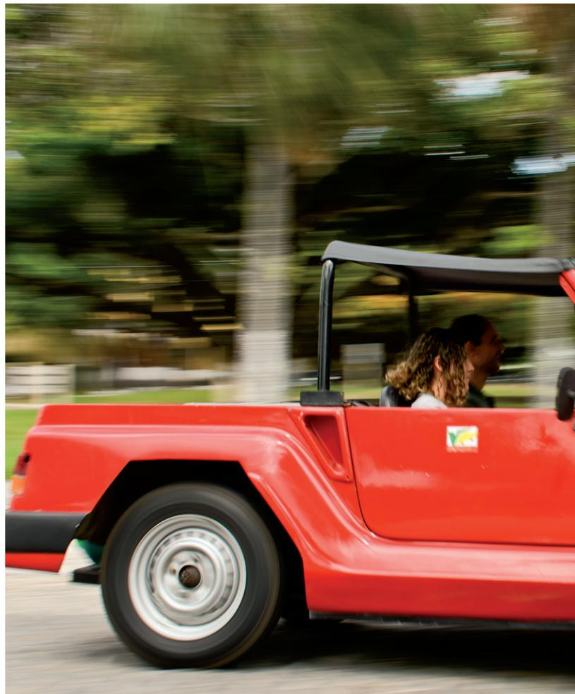
Para rodar, são necessários ao Patativa um banco de 36 baterias de chumbo-ácido, um motor de indução trifásico e um circuito eletrônico de potência, o “coração do carro”
