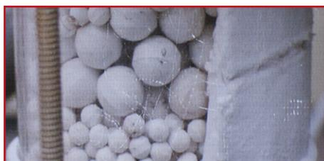
A **matriz porosa** dentro da caldeira é feita com esferas de alumina (Al<sub>2</sub>O<sub>3</sub>). Peculiaridade do projeto, aumenta a retenção de calor e potencializa a eficácia da caldeira.
