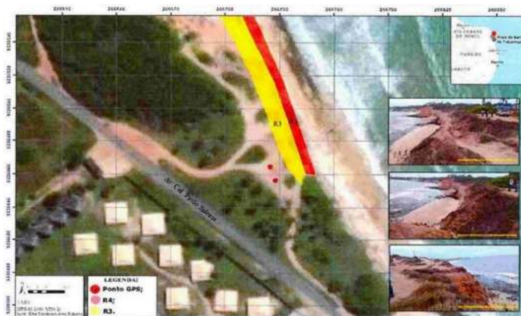
Mapa 28: Setorização de risco na praia da Barra de Tabatinga, pela COPDEC (em fev/2019), identificando as áreas com riscos alto (R3) e muito alto (R4) de desastre no Ponto 01.
