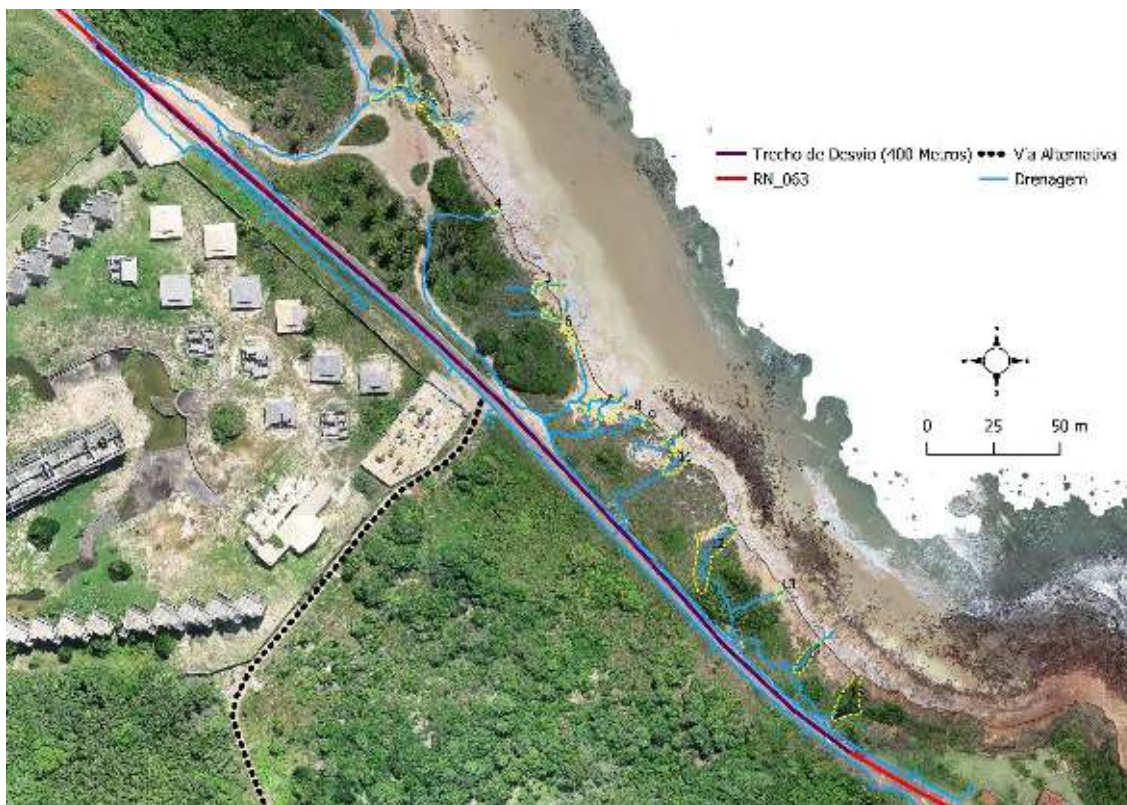
Mapa 45: Trecho da RN-063 que precisa de retificação no escoamento das águas pluviais.
