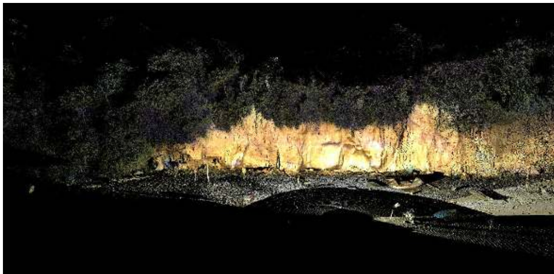
Figura 17: Nuvem de pontos obtidos com Laser Scan de porção inicial da falésia na Praia do Centro (distrito de Pipa).
