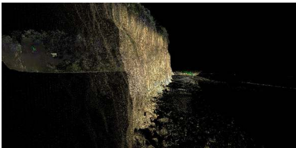
Figura 18: Visualização ortogonal da nuvem de pontos da falésia da Praia do Centro em Pipa.
